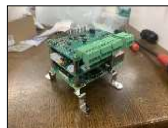
図7 ADPiを取り付けたRaspberry pi3B
